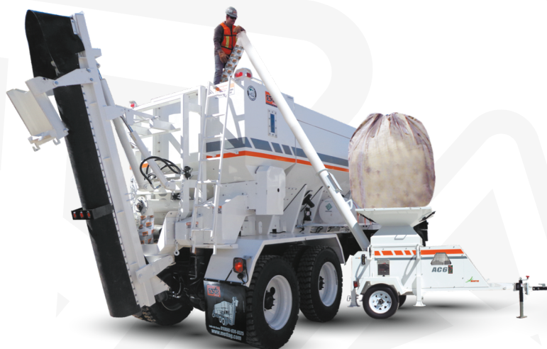
Recarga con super sacos de 2 tons.
